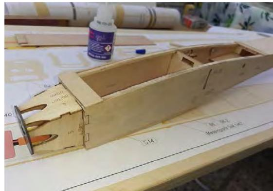
Die Beplankung ist aufgebracht und eine große Wartungsklappe ist ebenfalls berücksichtigt worden, soweit -so gut. Der Motorspant hält einen kleinen AHA-Effekt für den Bastler bereit, der wird nämlich so verleimt, dass sich dadurch der Motorsturz und Seitenzug ergeben. Ein kleines Bauteil mit Pfiff, wenn man so will.
