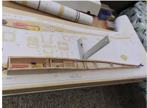
Die Seitenwände und Spanten sind verleimt. Es ist an der Zeit, die obere und untere Beplankung vorzunehmen, damit der Rumpf seine Stabilität erhält. Im rechten Bild ganz gut zu erkennen, von wo die Fläche später angesteuert wird.
