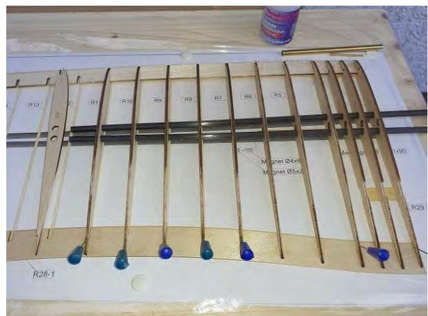
Zwischen die beiden Kohlefaserrohre wird nun noch eine Messinghülse eingeleimt, die an dem äußeren Ende, bei R7, zwei kleine Magnete aufnimmt und somit verhindert, dass sich die Flächenhälften von ihrem Flächen(stahl)stab entfernen. Auch in der Nasenleiste wird eine kleine Messinghülse sein neues Zuhause finden, sie dient der späteren Anlenkung durch das jeweilige Servo.
