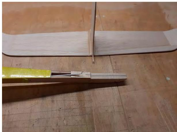
Das neue Kreuzleitwerk ist fertig und wartet auf die Positionierung. Auf die Anlenkung für das Seitenruder wollte ich nicht verzichten und diese blieb somit erhalten.
