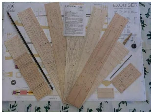
Neben dem vielen Sperr – und Balsaholz gibt es den Bauplan (1:1), die Bauanleitung sowie diverse Anlenkungsteile dazu. Die Messing- und Kohlefaserröhrchen für den späteren Tragflächenbau sind ebenfalls enthalten, wie auch der Motorspant. Es ist wirklich schwer, einem sofortigen Zusammenbau zu widerstehen, aber nur einen Tag später wurde Hand angelegt.
