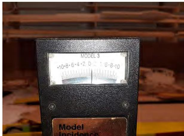
Nun wurde das Widerlager - für das Leitwerk – solange beschliffen, dass die Fläche - in Neutralstellung - die „Null“ auswies. Das hierfür die Aufnahme für das V-Leitwerk geopfert werden musste, das war uns schon im Vorfeld klar, aber wir hatten sowieso
