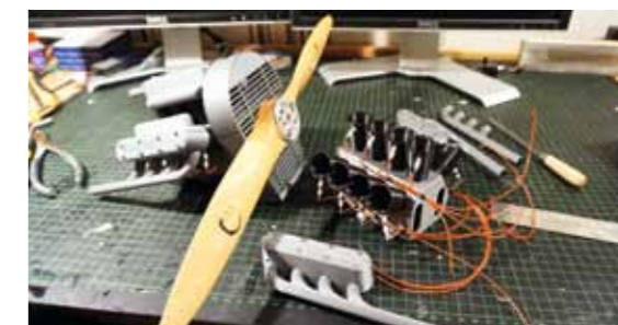
Auch beim Motorenbau kamen die Optionen moderner 3D-Drucker voll zum Tragen. Sie erlaubten eine detaillierte Umsetzung der speziellen, mehrzylindrigen Napier-Flugmotoren, die den Brushless-Getriebe-Antrieb umschließen
