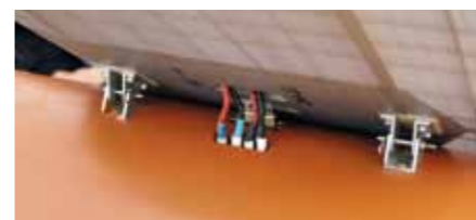
Interessant ist hier weniger der Blick auf die Verkabelung, sondern die beiden Rumpf-Flächen-Verbinder, die erstens eine Demontage des Flächenmittelstücks ermöglicht und zweitens über die Scharnierfunktion eine exakte Ausrichtung gestattet
