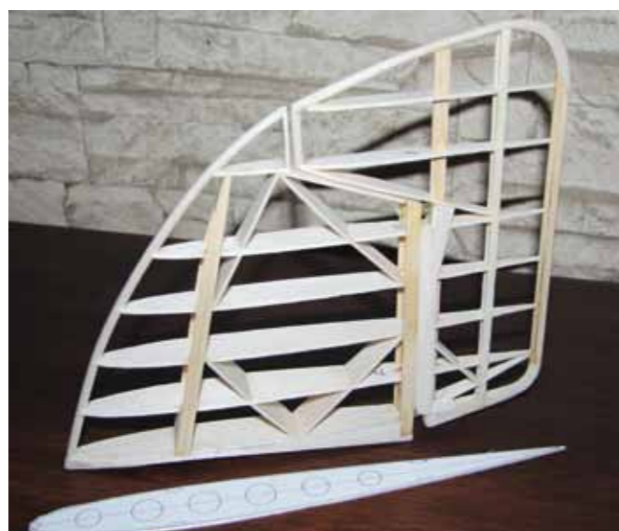
Eins von drei Seitenleitwerken. Bereits beim Bauen wurde eine Kehlagerung berücksichtigt
