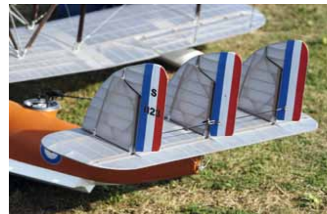
Angesteuert sind alle drei Ruder über ein einziges, kräftiges Servo. Dieses wirkt auf das mittige Ruder, die beiden anderen werden mitgenommen. Man beachte auch die Befestigung beziehungsweise Fixierung der Leitwerke
