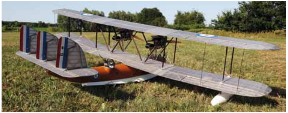
Statt Bügelfolien aufzubringen, kam bei der Mk-1 das Material Icarex zum Einsatz. Das ist sehr stabil und lässt auch den Blick unter die Verspannung zu
