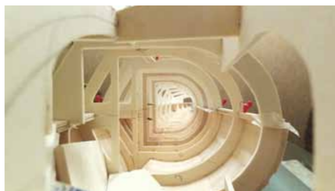
Der Blick in den Rumpf offenbart noch einmal die Bauweise in zwei Hälften. Sie gestattete erst den verzugsfreien Aufbau
