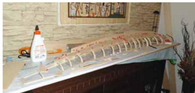
Die Dimensionen des Projekts sprengten den üblichen Rahmen, auch was den Bauort betraf. Hier wird aktuell die linke Rumpfhälfte beplankt
