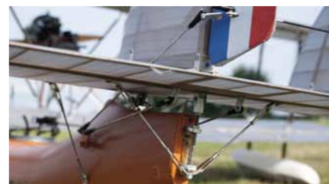
Das Höhenleitwerk liegt auf nur zwei Haltepunkten auf dem Rumpf auf, also nicht über die gesamte Auflagefläche, sodass eine stabile Verspannung erforderlich ist
