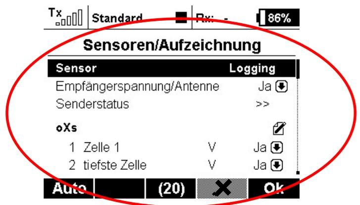
Beim aktiven Loggen wird das Viereck zum Kreis und zeigt an, dass geloggt/gespeichert wird. Gespeichert wird auf die SD Karte im Sender. Die Daten sind sehr klein, die Speicherkapazität reicht für viele Jahre
