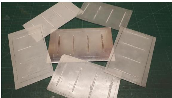
wie die effizient dargestellt werden können, wurde die Idee entwickelt, die Oberflächenhaut mittels GFK zu erstellen. Als Negativ-Form sollten Alu-Flachprofile dienen, in die Sicken eingefräst wurden. Jedoch stellte sich an einem Alu-Teststück heraus, dass sich die Sicken nicht blasenfrei mit dem eingefärbtem Epoxy-Harz herstellen ließen. Unzählige Versuche mit unterschiedlichen Harzkombinationen, Ausgasungs- und
