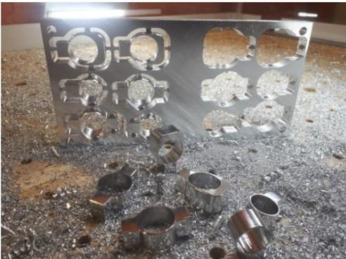
Erst als sicher war, so könnte es funktionieren, wurde die Mechanik aus hochfestem Aluminium gefräst. Die Federbeine wurden aus passenden Steckrohren gefertigt, ein Federberechnungsprogramm unterstützte die Dimensionierung der Federn.
