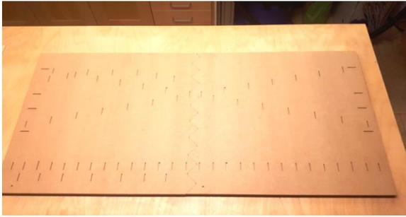
Jan oblag es nun, die Tragfläche aufzubauen. Dazu wurde zunächst für das Baubrett in eine MDF-Grundplatte Schlitze für die Rippenfüßchen eingefräst. Beide Tragflächenhälften spiegelverkehrt sowie das Mittelteil können nun auf der gleichen Grundplatte aufgebaut werden.
