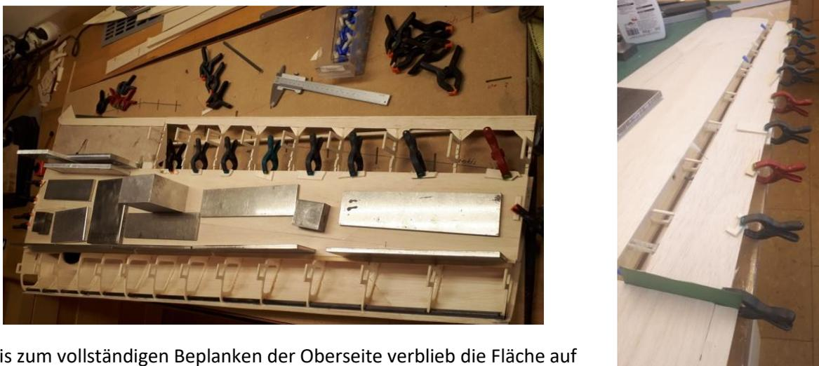
Bis zum vollständigen Beplanken der Oberseite verblieb die Fläche auf ihren Stützfüßchen, eingespannt auf dem MDF-Baubrett. Damit auch die Unterseite verzugsfrei beplankt werden konnte, wurde kurzerhand aus preiswertem Styropor eine Negativ-Form der Flächenoberseite gefräst, in die anschliessend die Fläche sauber gebettet werden konnte.
