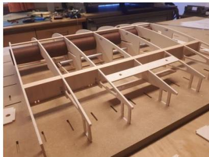
nun alle vorbereiteten Einbauten, wie Steckungsrohr, Fahrwerksaufnahme, Holme, Holmverstärkung, Nasen- und Endleiste einzukleben.
